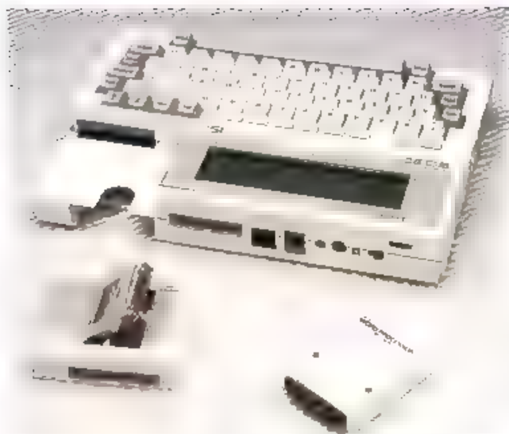
L'IAS 11 est proposé avec un lecteur de microcassettes et une cartouche ROM contenant l'éditeur de texte
